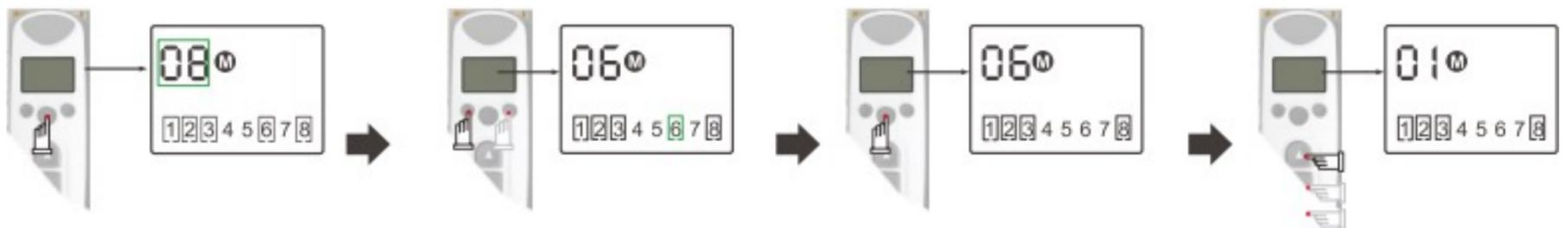
K2-Taste 2 Sekunden lang gedrückt halten, um in den Gruppenbedienungsmodus zu gelangen, die Ziffer in der oberen linken Ecke des Displays zeigt den aktuellen Kanal
