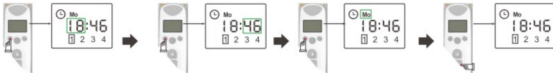
K1-Taste drücken, um in das Uhrzeitmenü zu gelangen. Es werden Uhrsymbol und Stundenanzeige auf dem Display angezeigt. Stunden über die Auf- / Ab-Taste einstellen.
