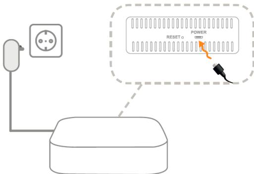
Eine Verbindung mit der SELVE Home Install App ist möglich, wenn die Status-LED orange leuchtet. Der Server befindet sich im Access Mode und stellt eine eigene WLAN-Verbindung zur Verfügung.
