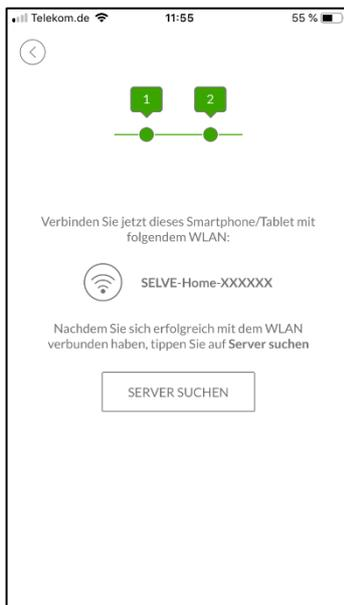
In die Einstellung des Smartphone oder Tablets wechseln und auf die WLAN-Verbindung SELVE-Home-XXXXXX wechseln. Der Verbindungsaufbau kann bis zu 1 Minute dauern und wird durch das WLAN-Symbol angezeigt.
