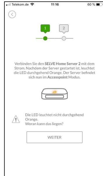
Wenn die LED durchgehend orange leuchtet, befindet sich der Server im Access-Modus und stellt eine eigene WLAN-Verbindung zur Verfügung. Setup weiter fortsetzen.
