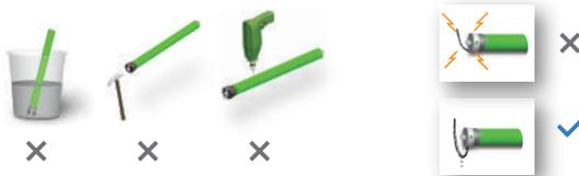
Um ein Einlaufen von Wasser zu vermeiden, sollte das Kabel während der Montage wie auf dem Bild verlegt werden.
