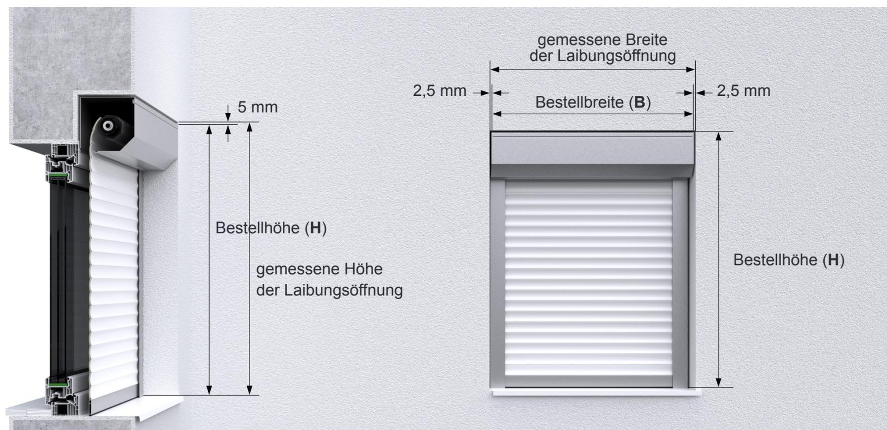
Der Rollladenkasten sowie die Führungsschienen werden innerhalb der Laibungsöffnung, also auf dem Fensterrahmen montiert.
