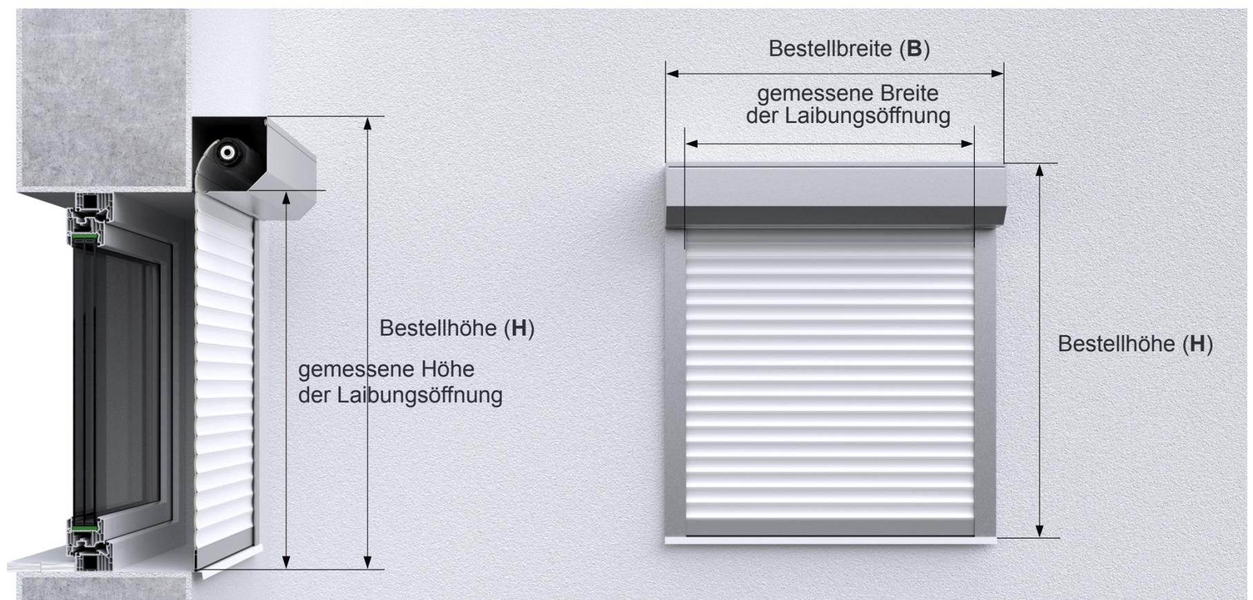
Der Rollladenkasten wird auf der Wand oberhalb der Fensteröffnung montiert, die Führungsschienen jeweils links und rechts daneben.
